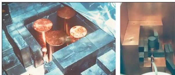
Рис.7. Эксперимент Гейдельберг—Москва в подземной лаборатории Гран Сассо (Италия). Четыре HPGe-детектора из обогащенного германия в процессе сборки (слева) и пятый детектор из обогащенного германия, размещенный в отдельной защите (справа).
