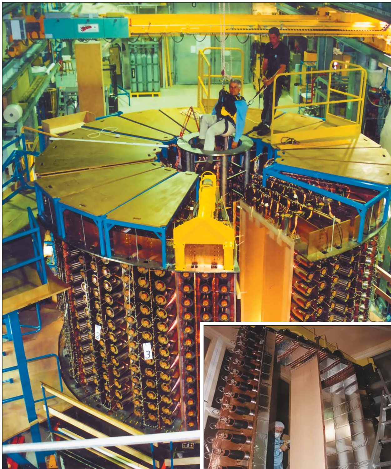
Рис.9. Детектор NEMO-3 (слева) в процессе сборки (подземная лаборатория в Модане, Франция). Детектор состоит из 20 секторов и после сборки будет окружен многослойной пассивной защитой. Один из секторов перед установкой в детектор (справа). В центре расположен источник с исследуемым материалом. Хорошо видны сцинтилляционные счетчики (обмотанные алюминизированным майларом) и электронные фотоумножители (слева).
